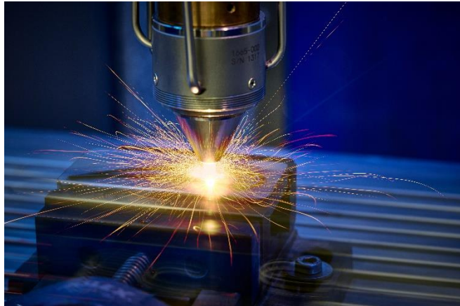
Bild 4: Für Anwendungen der Wasserstoff-Industrie eignet sich das Laserauftragschweißen (engl. Laser Material Deposition, LMD) – etwa zur Herstellung von Elektrolyseuren, die oft aus unterschiedlichsten Werkstoffpaarungen bestehen. © Fraunhofer ILT, Aachen.
