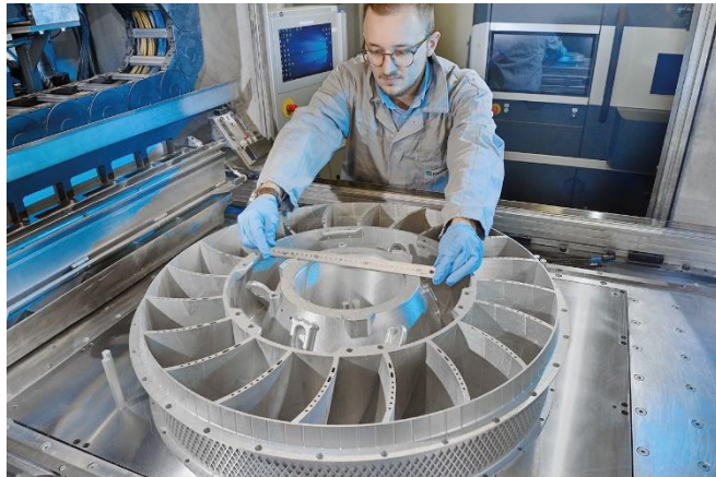
Bild 5: Durch kontinuierliche Verbesserungen ist die Additive Fertigung in der Luft- und Raumfahrt zu einer Schlüsseltechnologie geworden. Damit können Prototypen schneller erstellt, getestet und optimiert werden, was zu einer beschleunigten Innovationsrate führt. © Fraunhofer ILT, Aachen.
