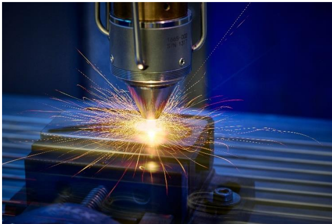
Bild 3: Hochproduktiven 3D-Druck ermöglicht der Einsatz der EHLA-Technik in einer Parallelkinematik und in einem modifizierten 5-Achs-CNC-Prototypen. Mit der Parallelkinematik ließen sich z. B. erste Komponenten aus Edelstahl 316L mit 1,7 kg/h bei einem Vorschub von 40 m/min. schnell und zuverlässig drucken. © Fraunhofer ILT, Aachen.
