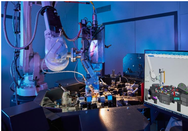
Bild 7: Im EFRE.NRW-Projekt MultiPROMobil wird eine flexible und rekonfigurierbare Arbeitszelle mit skalierbaren Fertigungssystemen und Profinet-Anbindung zum digitalen Zwilling entwickelt. © Fraunhofer ILT, Aachen.
