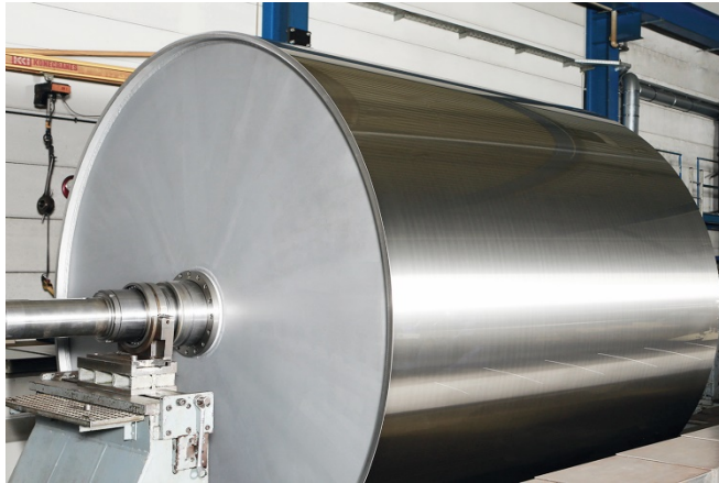
Bild 2: Zukünftig sollen mit geeigneter Systemtechnik auch große Walzen mit einem Durchmesser von bis zu 3.000 mm endkonturnah und prozesssicher beschichtet werden. @ Drink & Schlössers.
