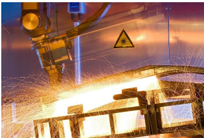
Bild 2: Bearbeitung eines Kfz- Strukturbauteils mit dem multifunktionalen Laserwerkzeug. © Fraunhofer / Thomas Ernsting.
