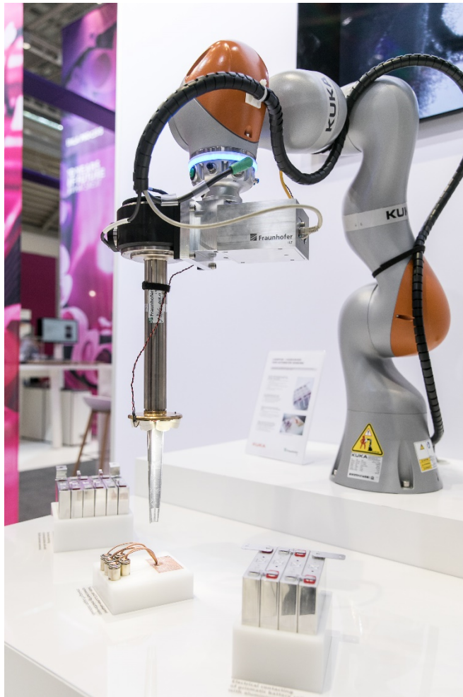
Bild 4: Laser ermöglichen in der Batterietechnik schon heute präzise und stabile Verbindungen: Mit dem Laserbonden lassen sich z. B. Kupferbändchen auf Batteriezellen schweißen. © Fraunhofer ILT, Aachen / Klaus D. Wolf.
